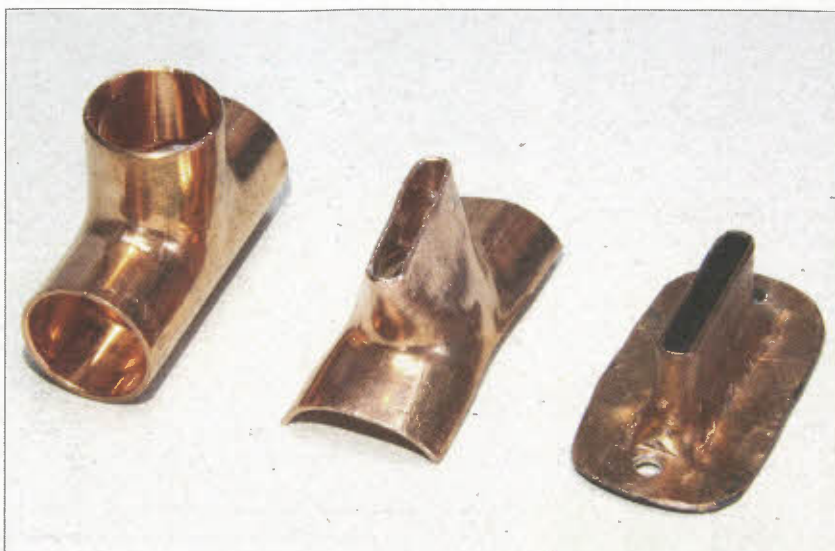
So wird aus einem Kupfer-T-Stück eine maßgeschneiderte Blende ...
